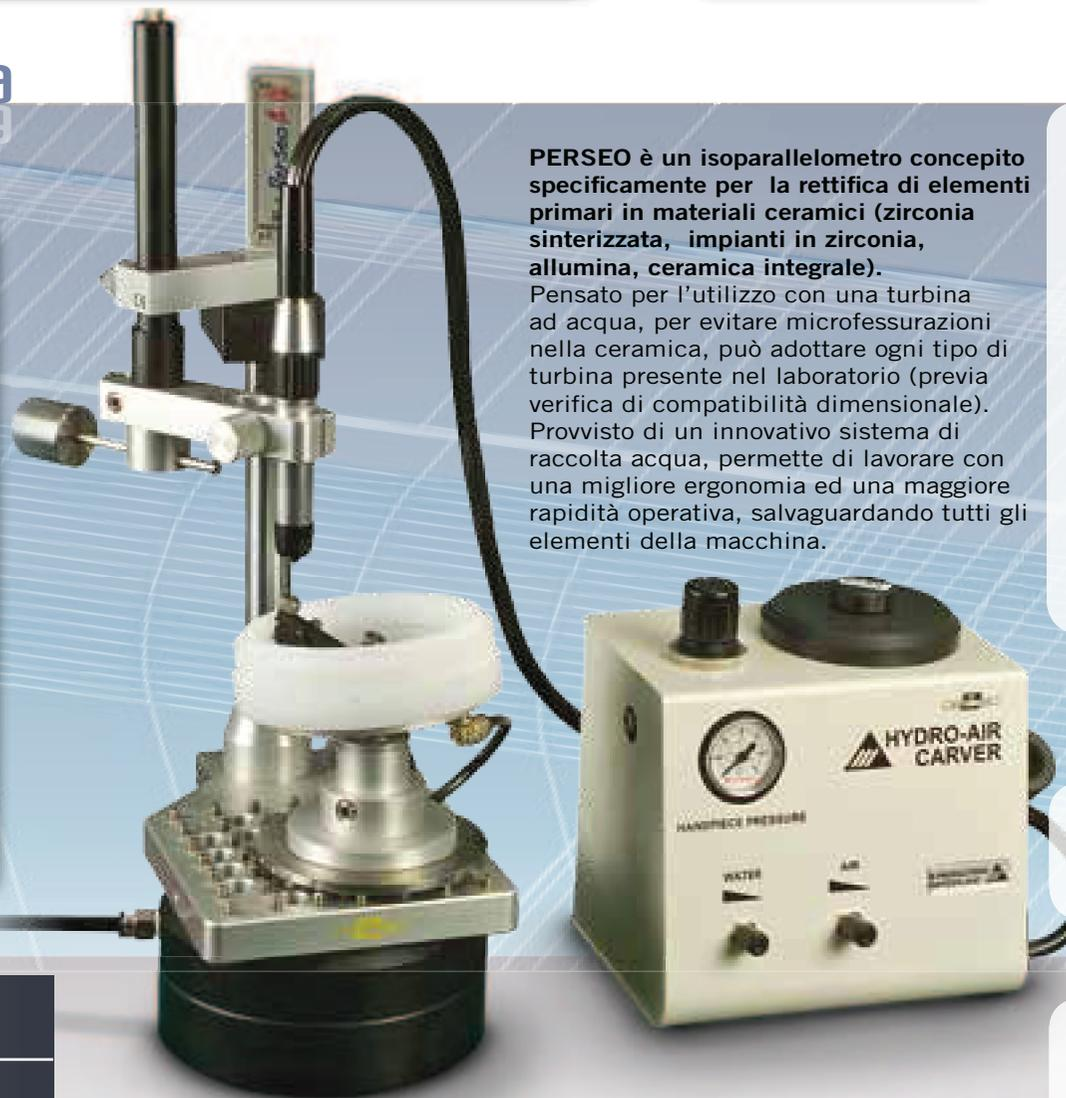
**PERSEO è un isoparallelometro concepito specificamente per la rettifica di elementi primari in materiali ceramici (zirconia sinterizzata, impianti in zirconia, allumina, ceramica integrale).**
