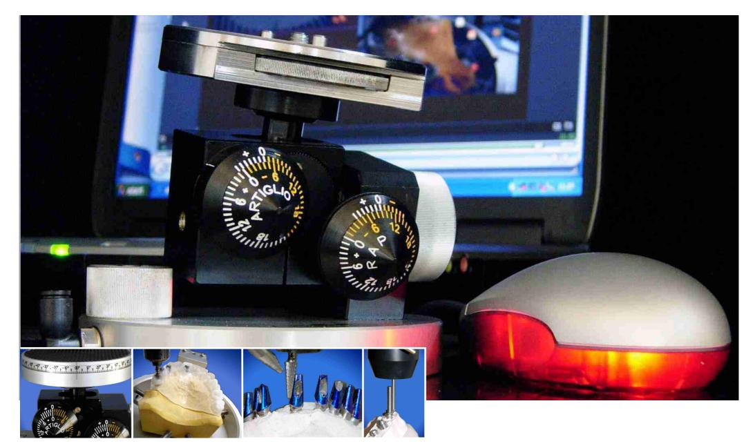
Rilevamento e riproduzione asse d'inserzione generale, asse di ogni singolo elemento ed asse di ogni singolo impianto I goniometri della base RAP permettono di misurare l'asse d'inserzione e consentono la ripresa dell'asse stesso dopo la movimentazione del modello
